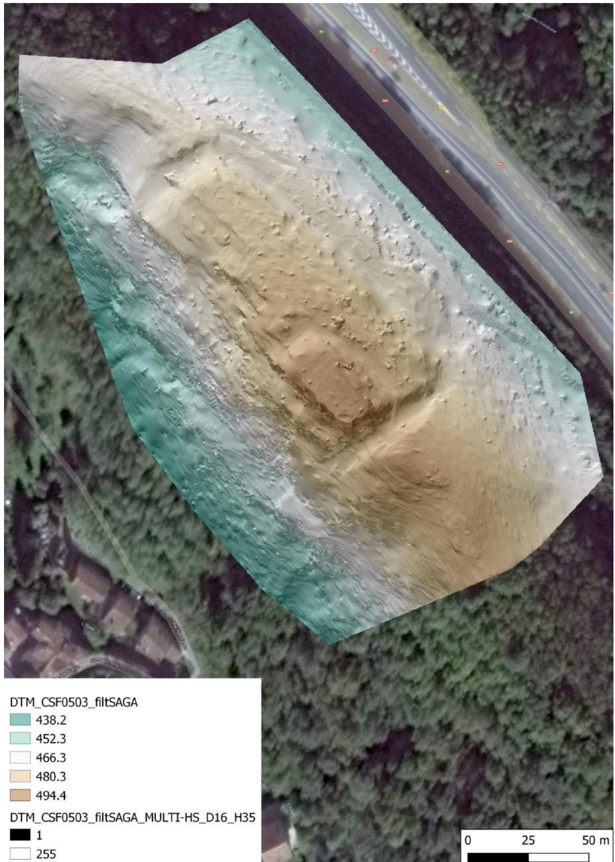
Figure 5 - Labarre, Foix (09)- Mission du 22/02/2019 - Multihilshade - 16 directions - 35 degrés
